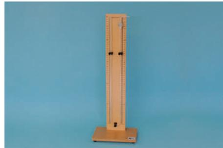
1| Con llave de paso situada cerca del fin de una de las ramas y montado sobre un soporte.
