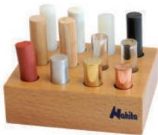
1 | Compuesto por 12 cilindros de diferente material y diferentes longitudes (38mm-60 mm), pero mismo diámetro de 12,5 mm.
