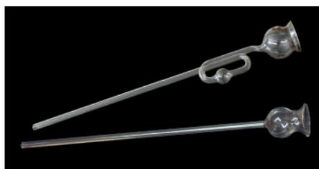
1 | Pueden insertarse en pequeños orificios de tapones. Facilita la adición de líquidos a matraces cerrados. Evita pérdida de gases generados en determinadas reacciones. Longitud 300 mm.
