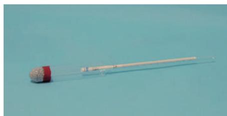
1 | Indicados para determinar la densidad de derivados de petróleo. Según ISO3675. Calibradas a 15°C cumpliendo la norma ISO 649-1.
