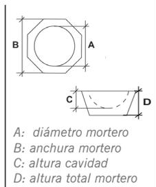
1 | Se suministran con mano. Ideal para triturar y mezclar sustancias de alta dureza. Interior y mano pulidas y superficie exterior lijada uniformemente.
