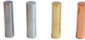
1 | Set para determinar la gravedad específica compuesto de cuatro varillas cilíndricas del mismo tamaño pero de diferentes materiales: latón, aluminio, cobre y hierro.
