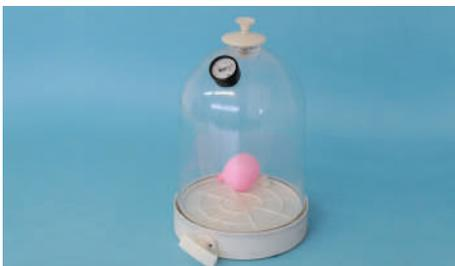
1| Instrumento diseñado para demostrar el efecto de la presión atmosférica.
