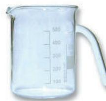
1 | Para determinar densidad según principio de arquímedes. Vidrio borosilicato. Con tubo de vertido.
