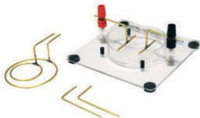
1 | Para el estudio del campo eléctrico generado por diferentes configuraciones de electrodos.
