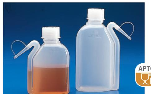
1 | Con tubo moldeado de forma integral al frasco.
