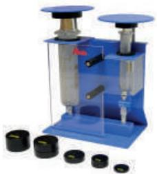
1| Compuesto por un par de jeringas graduadas de vidrio de capacidades 50 y 10 cm<sup>3</sup> y proporcionan una ratio de área transversal de 3:1.
