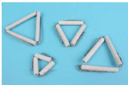
1| Formados por tres tubos de arcilla refractaria a base de silimanita. Unidos en forma de triángulo mediante gruesos alambres de metal galvanizado. Para la sujeción de crisoles durante el proceso de calcinación.
