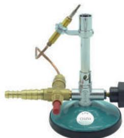
1| Con válvula de seguridad homologada y controlada por termopar que corta el suministro de gas en caso de extinción accidental de la llama.
