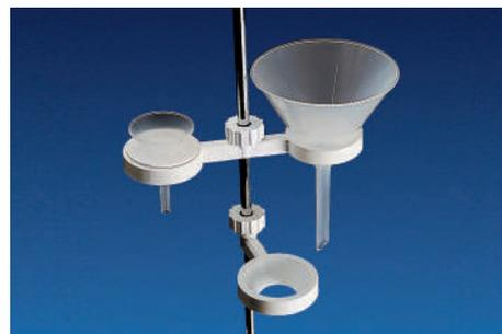
1 | Individual o doble para embudos de 25 mm (con adaptador incluido) a 170 mm.
