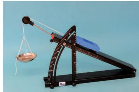
1 | Compuesto de 2 placas metálicas unidas mediante bisagra en uno de sus extremos; una de las placas se utiliza como base y la otra como plano inclinado.
