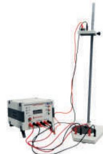
1 | El equipo consta de un electroimán montado sobre una carcasa de plástico que permite liberar una bola metálica adherida a una barra de sección cuadrada.
