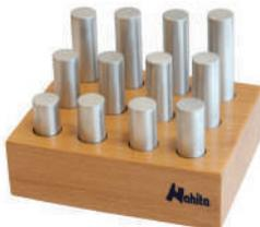
1 | Compuesto por 12 varillas de aluminio cada una de diferente longitud (diferente masa y volumen) pero del mismo diámetro de 12,5 mm. Útil para mostrar la densidad constante con variación de tamaños. También se puede utilizar para estudiar la capacidad calorífica específica del material.
