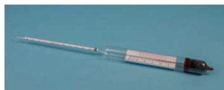
1 | Indicado para la determinación de la concentración de azúcar en una solución. En escala Brix (1 °Brix equivale a 1 g de sacarosa por 100 g de solución (1% en peso). Calibrado a 20 °C. Presentación en estuche individual.
