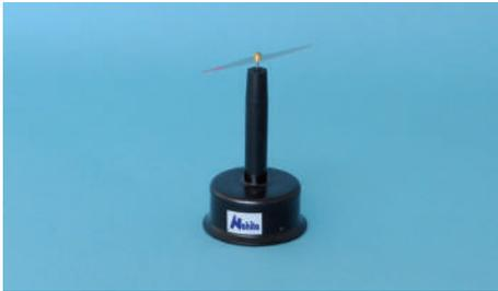
1 | Base circular en baquelita con pilar no magnético y soporte en acero al carbono sobre el que pivota la aguja.
