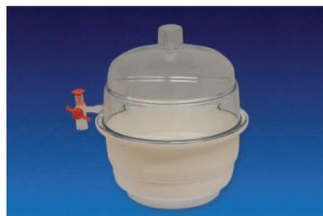
1| Base y disco de polipropileno (PP), tapa de policarbonato (PC). Autoclavable. Oliva de conexión: 10 mm. Llave de PTFE de 3 vías. Vacío hasta 740 mm/Hg/24h.
