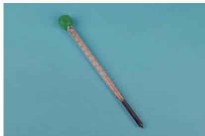
1 | Insertado en carcasa protectora de aluminio. Líquido orgánico coloreado no contaminante o peligroso.
