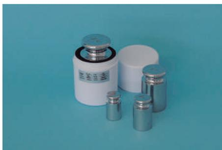
1 | Pesas de alta precisión indicadas para control, calibración y ajuste de balanzas analíticas en clase de verificación I, con una resolución máxima de aproximadamente 100000 d. Fabricadas en acero inoxidable.
