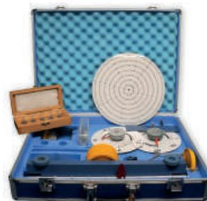
1| Componentes: 1x dinamómetro 1N, 1x dinamómetro 2N, 1x tramo inclinado, 2x platos para pesar, 2x pesas con gancho, 1x palanca de equilibrio, 1x soporte con escala, 4x ganchos con forma en "S", 3x sujetas imanes, 4x pernos cordados, 1x muelle, 2x soportes con imán, 1x set de pesas, 1x cinta métrica con escala en bloques, magnética, con puntero 1x tabla Torque, 1x soporte polea, 1x nivel, 1x polea de 48mm, 1x polea de 106mm.
