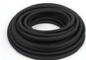
1 | Muy buena resistencia química y a la abrasión. Baja permeabilidad al gas en comparación con los tubos de goma. Termosoldable y termodeformable. Densidad= 0,98 – Dureza Shore=61. Temperatura de -60°C a +135°C.
