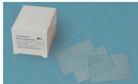
1 | Grosor de 1 mm. Fabricados en vidrio soda. Bordes cortados.
