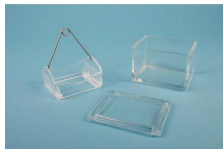
1 | Fabricada en vidrio prensado, de gran resistencia con tapa de vidrio. Cubeta con cestillo y asa de acero inoxidable.
