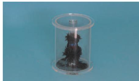
1 | Compuesto por una cámara hueca fabricada en material acrílico transparente con un orificio en su parte central para poder alojar el imán cilíndrico.
