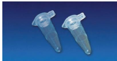
1| Fondo cónico, con tapa plana. Estérilizable en autoclave, pueden ser congelados a -20 °C.
