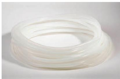
1 | Traslúcido, hidrófobo, mínimo estiramiento, muy buena superficie. Alimentaria según FDA y BgVV. Densidad= 1,19 – Dureza Shore A=60±5 (es- tándar). Temperatura de -50 °C a +200 °C (esterilizable al vapor).
