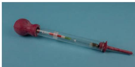
1 | Permite comprobar el estado del electrolito de una batería. Cuerpo de vidrio resistente, con perilla y tubo de succión. Calibrado a 20°C.
