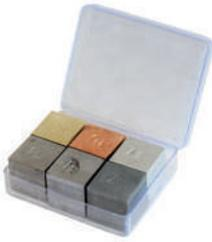
1 | Juego de 6 cubos de diversos materiales; suministrado en caja. Compuesto por 1 cubo de 20mm de cada material: Latón, Plomo, Hierro, Cobre, Aluminio y Zinc.
