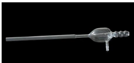
1 | Presión de agua mínima 4 kg/cm<sup>2</sup>. Vacío aproximado de 17 mm Hg.
