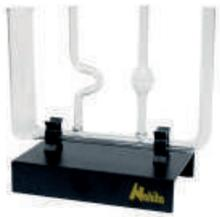
1| Compuesto de 4 tubos de vidrio cada uno con diferente diámetro de sección y forma, conectados entre sí en la base mediante un tubo de vidrio horizontal común a todos ellos, sellado en un colector y montado sobre un soporte.
