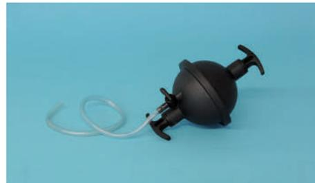
1| El aparato consiste en dos hemisferios de unos 100 mm de diámetro, ambos con un asa en su parte superior. Uno de ellos presenta una llave de plástico para la realización del vacío en el interior mediante una bomba de vacío y un anillo de goma en el interior para su correcto sellado.
