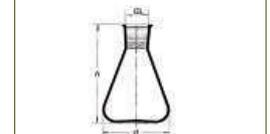
1 | Boca esmerilada para conexión y montajes. Graduación blanca con superficie de rotulación.
