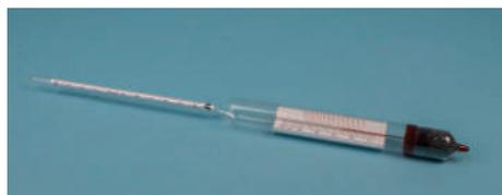
1 | Indicado para la determinación de la concentración de azúcar en una solución. En escala Brix (1 °Brix equivale a 1 g de sacarosa por 100 g de solución (1% en peso). Calibrado a 20 °C. Presentación en estuche individual.
