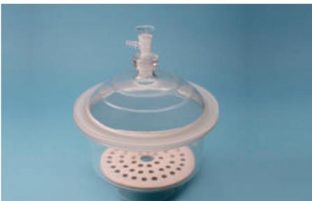
1| Tapa con tubuladura esmerilada y llave para vacío. Con disco de porcelana.
