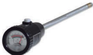
1 | Portátil y resistente para uso en agricultura y jardinería. Sensor integrado en el extremo cónico. No precisa alimentación.
