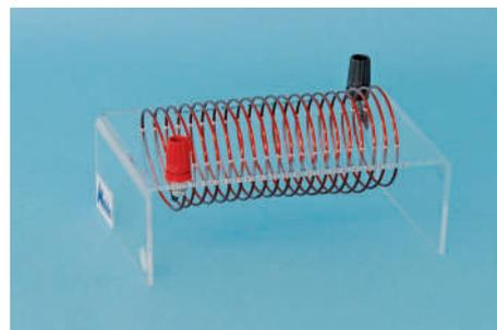
1 | Para el estudio y la demostración de campos magnéticos asociados a las distintas formas de un alambre conductor de corriente eléctrica. Disponibles 3 modelos:
